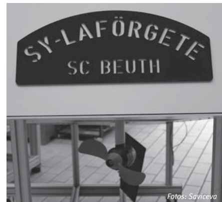
Heck des Beuth-Bootes „Laförgete“ mit versenkbarem Elektroantrieb
