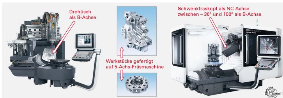
Bild 1.11: 5-achsige CNC-Fräsmaschine mit B- und C-Drehachse
