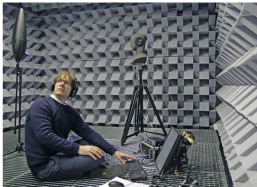
Kalibriermessung der abgestrahlten Schalleistung im reflexionsarmen Raum
