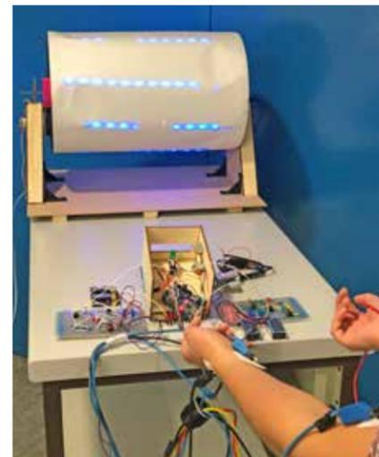
Der Muscle Laser Run in Aktion mit Klebeelektroden (unten), ansteuerbarem Laser (mittig) und rotierendem Spielfeld (oben)
