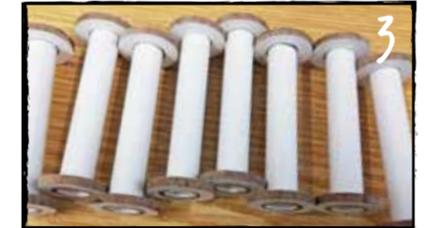
Auch die Spulenkörper werden im Labor hergestellt, dann beginnt der Profi mit dem Aufspulen an der Trafowickelmaschine.
